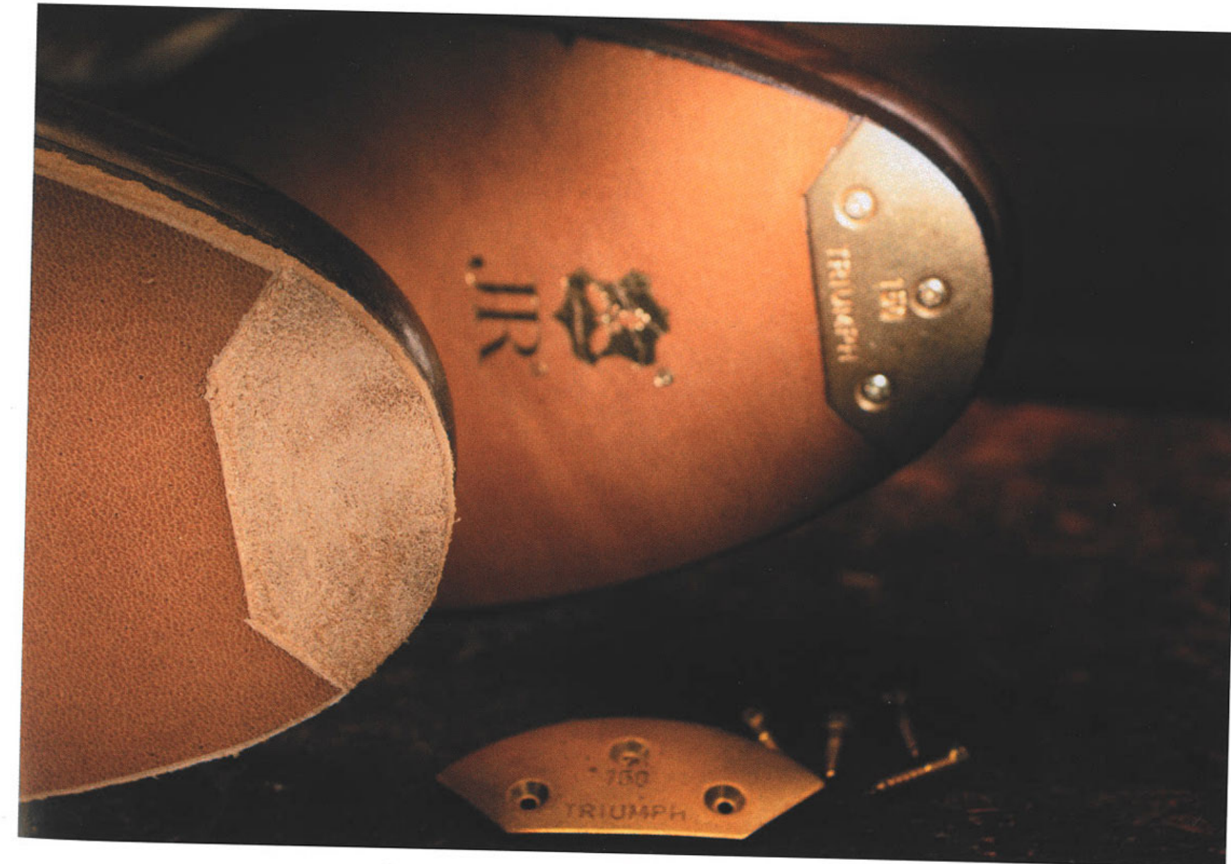
Unten rechts: Aus der Werkstatt von Shoedoc: Neue Laufsohlen von Rendenbach in Trier, Schuhspitzen mit eingelassenen Boulevardeisen.
