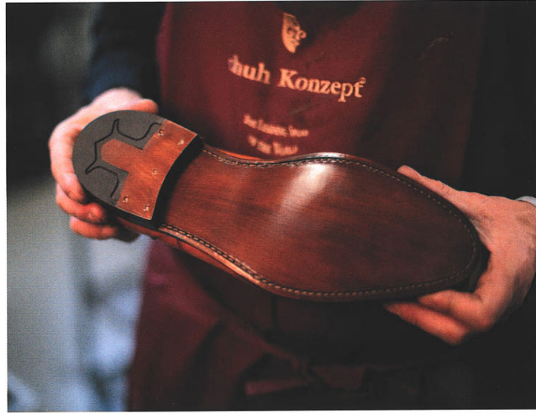
Oben: Ein rahmengenähter Schuh nach Komplettreparatur bei Schuh Konzept in Berlin. Die Laufsohle neu aufgedoppelt, Absatz mit Originalmaterial vom Hersteller des Schuhs.
